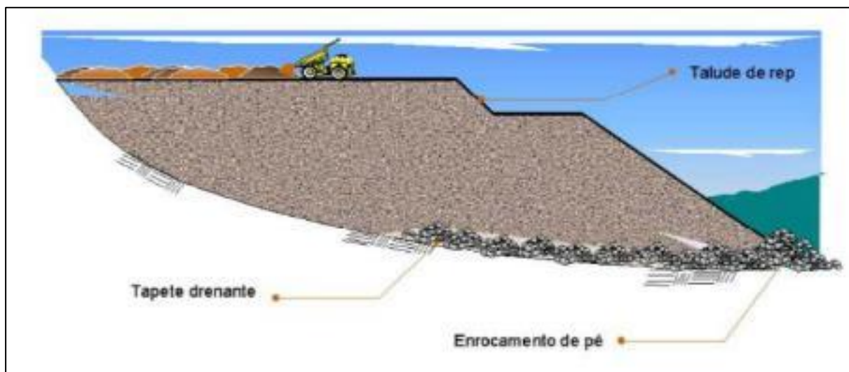
Figura 125. Esquema de construção de PDER por método ascendente
